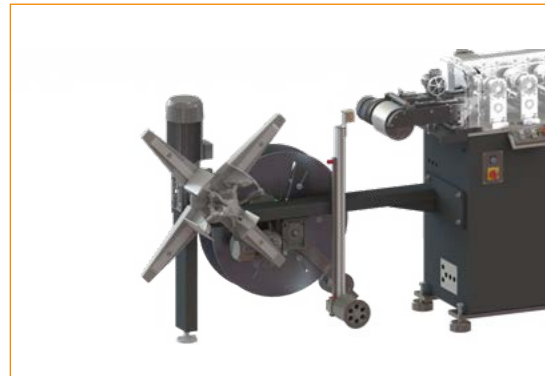
Ausrüstung zum Abwickeln von Aluminiumblech in der Maschine integriert
